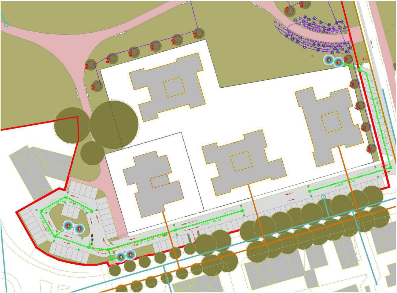
La superficie totale da drenare risulta di 3.200mq di cui 2.850 pavimentati ed impermeabili e 350 mq destinati ad aiuole inerbite e piantumate.
