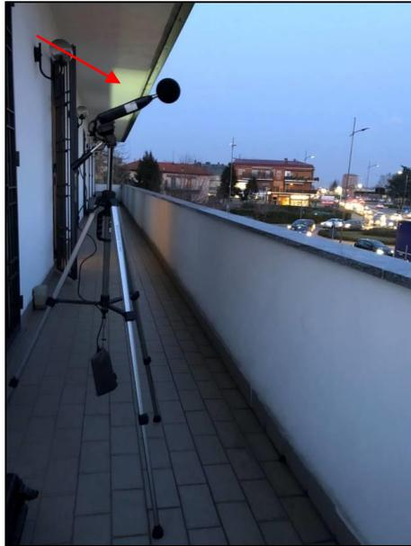
Foto 9 – Foto della posizione di misura P1 (scattata dal balcone sul quale era stato posizionato lo strumento, verso la SP ex SS11)
